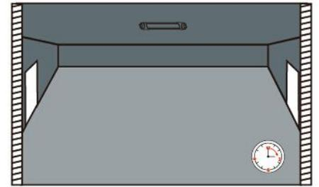
③ 在延时时间过后，如果没有检测到移动信号，灯会关闭。
